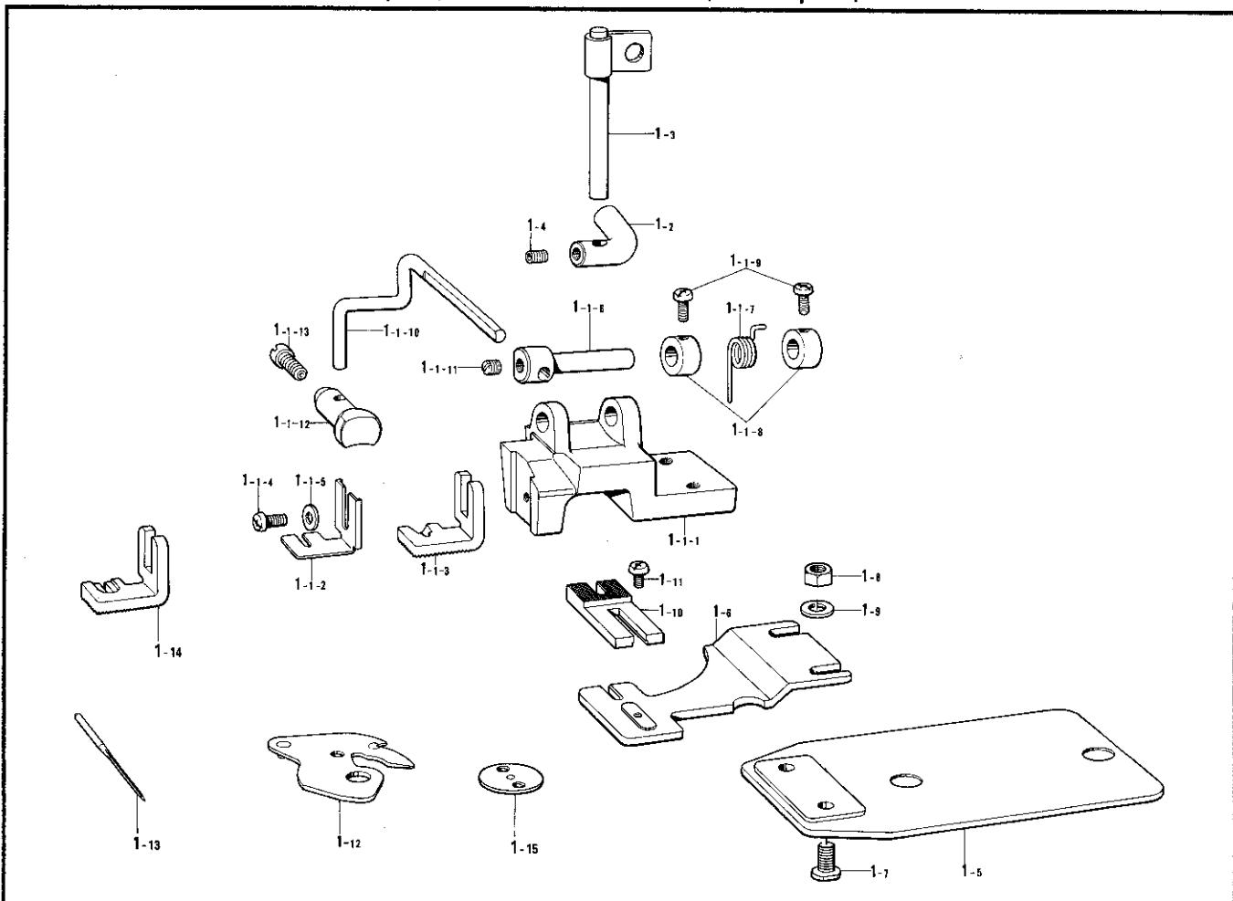
R. 動車・遊車関係/Drive pulley and idler pulley mechanism/Antriebsriemenscheibe und Riemscheibe
