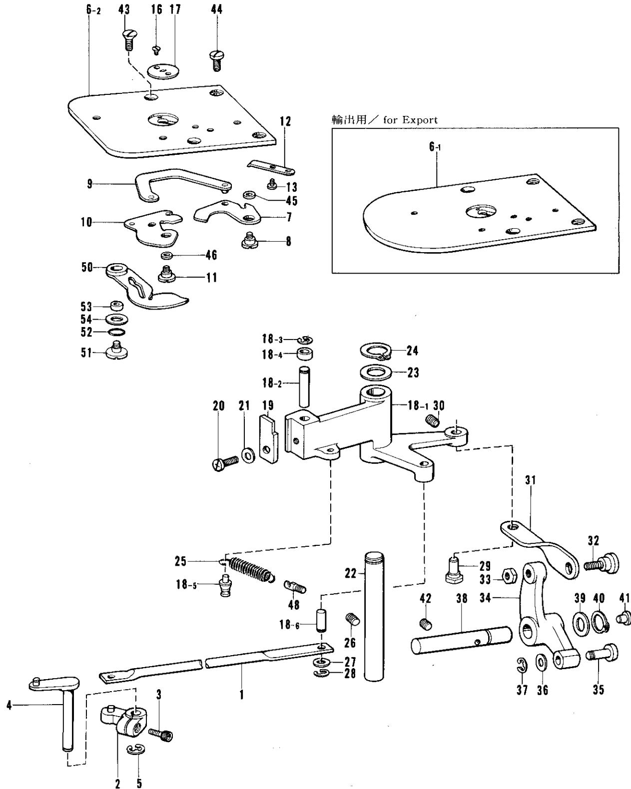
N. 糸切り関係 / Thread trimmer mechanism / Fadenabschneidevorrichtung
