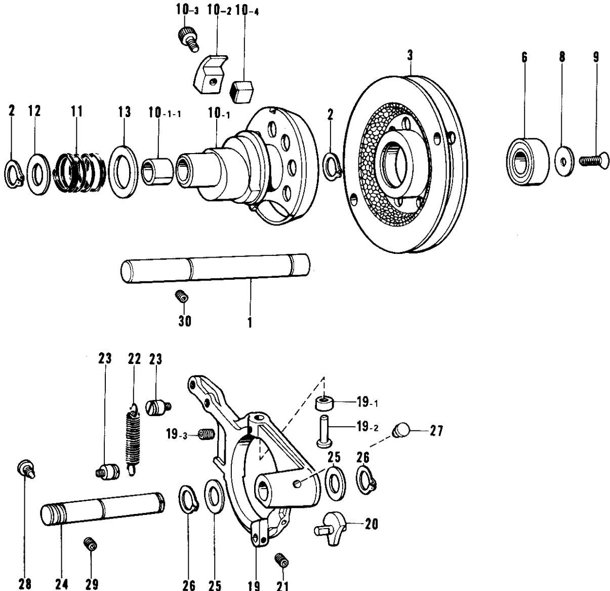
D. パワー押工関係/Power lift mechanism/Heberbetätigungs vorrichtung /
