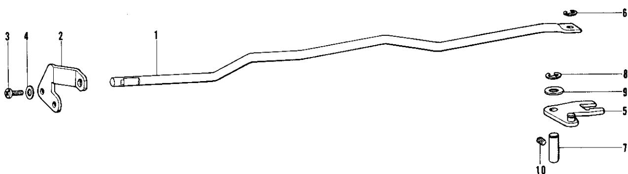
P. 糸拭イ関係 / Thread wiper mechanism / Fadenwischvorrichtung
