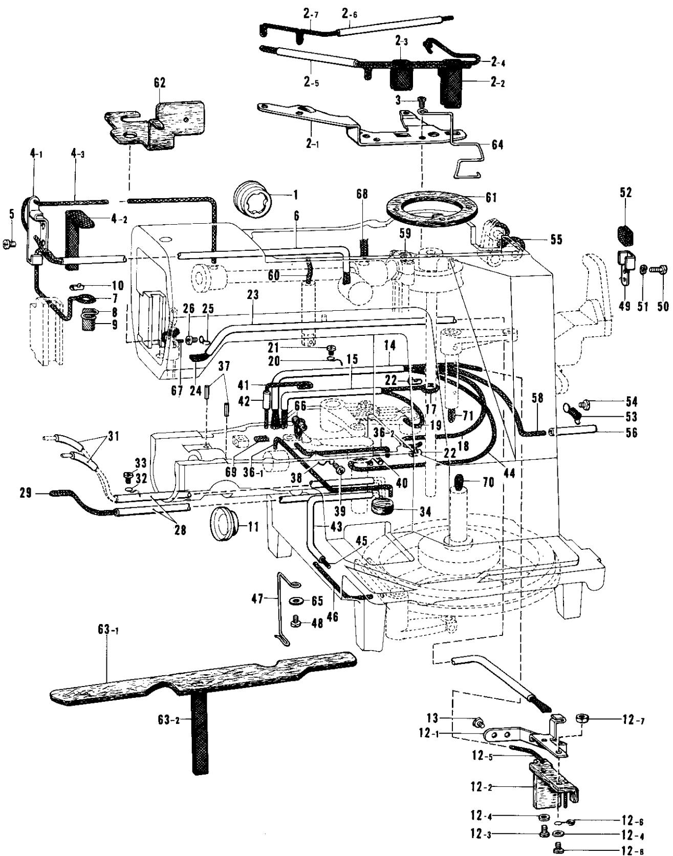
K. 給油・潤滑関係/Lubrication/Schmierung
