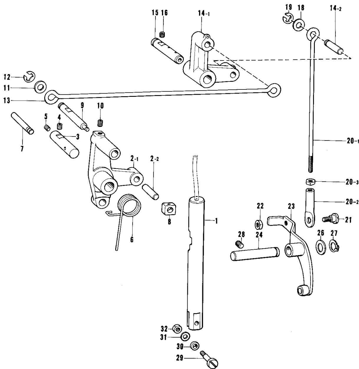
F. 押工上ヶ関係 / Work clamp lifter mechanism / Stoffhalterhebervorrichtung /
